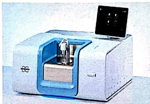
德国 Bruker 公司的最新型红外光谱仪 INVENIO R 采用 30 度入射角镜麦克尔逊干涉仪系统, 干涉仪无需自动准直。其技术指标如下: 光谱范围: 8000-350cm<sup>-1</sup>; 光谱分辨率: 0.16cm<sup>-1</sup>, 一分钟测试信噪比: 60000: 1, 波数精度: 0.0005cm<sup>-1</sup>, 配置纯金刚石 ATR 衰减全反射附件、原厂设计 20 度常规反射附件、原厂研发大尺寸积分球测试附件、干燥空气保护模块、固体样品压片机等红外常用测试模块。满足我们对特种光纤及光纤器件加工处理的需求。
