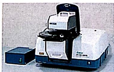
该系统利用 28 度入射振镜扫描干涉仪。保证极高的光通量。光谱分辨率为: 0.07cm<sup>-1</sup>, 远远超过测试要求。但光谱范围为: 7800-400cm<sup>-1</sup>, 范围较窄。波数精度为 0.01cm<sup>-1</sup>, 无法完全满足测试要求。所提供 ATR 为 Ge 晶体 ATR, 测试范围较窄, 且易损耗。其余积分球以及反射附件为第三方提供。
