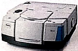
该系统利用振镜扫描式迈克尔逊干涉仪，工作时振镜的工作频率可达 100KHz。其光谱范围为  $7800\text{--}350\text{cm}^{-1}$ ，波数精度为  $0.01\text{cm}^{-1}$ ，光谱分辨率为  $0.09\text{cm}^{-1}$ 。一分钟测试信噪比 55000: 1，配置纯金刚石 ATR，反射附件，积分球附件以及干燥空气气路保护。其分辨率极高，但该分辨率下信噪比无法保证。波数精度无法满足测试要求，且其积分球附件为 OEM 至第三方，非厂家设计。
