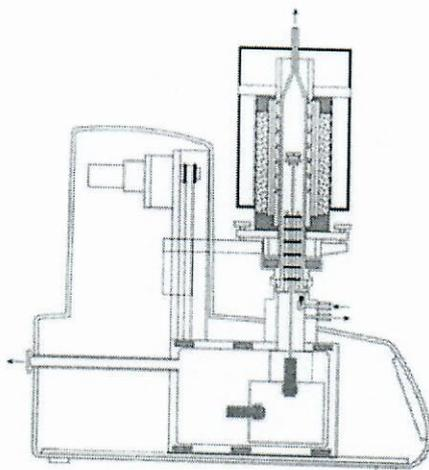
HDSC 和 DTA 系统的模块化设计概念可以通过可更换炉体实现  $-150^{\circ}\text{C}$  到  $1750^{\circ}\text{C}$  温度范围的测试。该真空密封设计可以实现在  $10\text{E}-5$  mbar 的真空下或最纯净气氛的环境下对焓和  $C_p$  (比热) 的定量测定。该系统经过升级可以带有可选的自动进样器以及耦合到 MS 或 FTIR。
